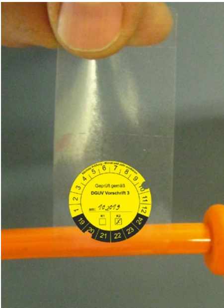
Abb. 7 Beispiel für eine Prüfbänderole zur Befestigung an der Leitung
